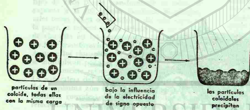
Fig. 3-11 Las partículas de un coloide llevan cargas eléctricas del mismo signo, positivas (izquierda) en este caso. Estas cargas hacen que las partículas se repelan mutuamente, manteniéndose de este modo en suspensión. Si se añade electricidad de signo opuesto (centro), las cargas del coloide son neutralizadas y las partículas precipitan (derecha)
