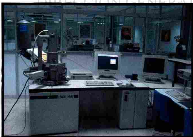
Imagen 12.- Microscopio electrónico de barrido utilizado para comparar las morfologías de las puzolanas.
