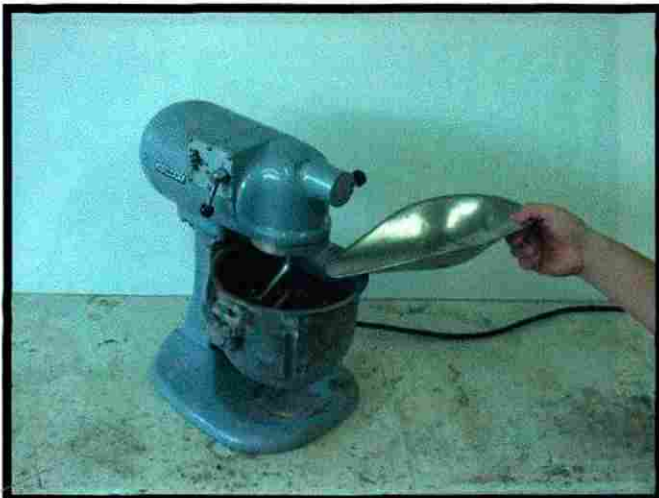
Imagen 13.- Mezcladora estándar utilizada para fabricar pastas y morteros.
