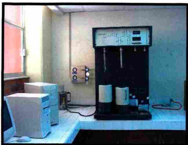
Imagen 10.- Equipo de adsorción de nitrógeno utilizado para determinar área superficial de los materiales.
