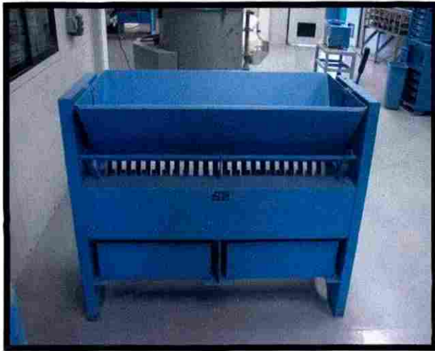
Imagen 4.- Cuarteador utilizado para obtener las muestras representativas de cada uno de los materiales.
