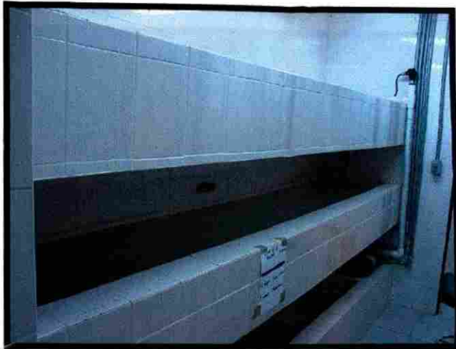
Imagen 16.- Pila de curado con temperatura controlada y recirculación de agua.
