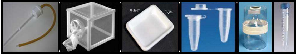
Fig. 6. Material para crianza de mosquito y separación de adultos: jaulas, charola, cámara de emergencia, aspirador bucal, tubos 10 ml falcon, y tubos eppendorf de 1.5ml.
