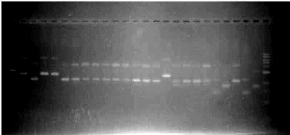
Figura 3.3 Patrón de bandas obtenido en las clonas analizadas, en el primer y último carril se colocó el marcador de peso molecular y del segundo carril en adelante aparecen los DNAs extraídos de las clonas 1 a la 24.
