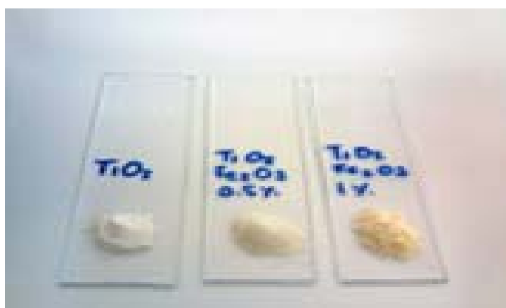
Figura 3.1 Polvos obtenidos por el método sol-gel. a) \text{TiO}_2 , b) \text{TiO}_2\text{-Fe}_2\text{O}_3 0.5% y c) \text{TiO}_2\text{-Fe}_2\text{O}_3 1%.
