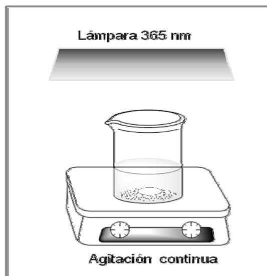
Figura 2.2. Esquema del sistema de degradación por fotocatalisis heterogénea.
