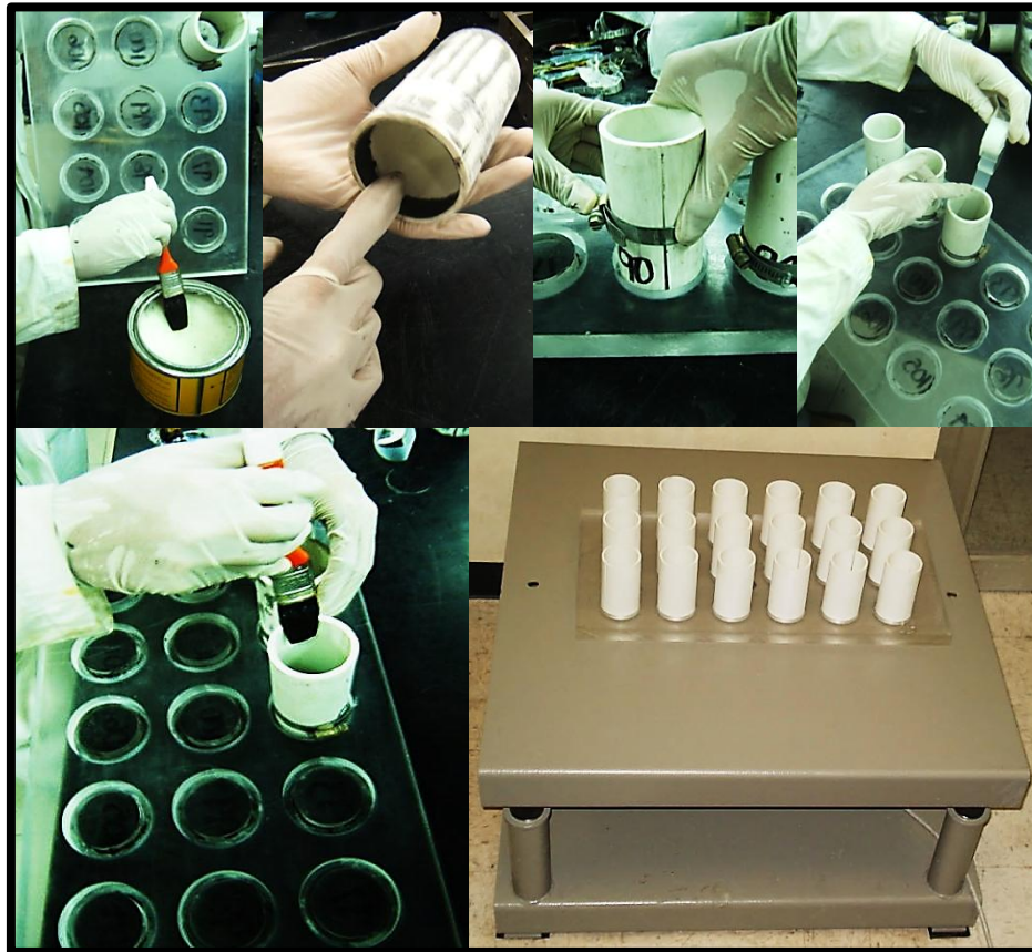
Figura 119.- Procedimiento para el acondicionamiento de los moldes.
