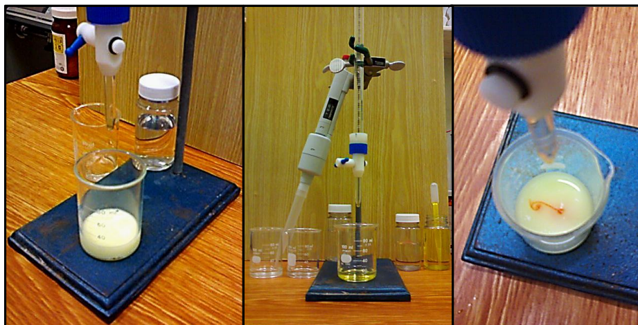
Figura 115.- Cambio de viraje exhibido en el agua que contenía los cloruros provenientes del NSG.
