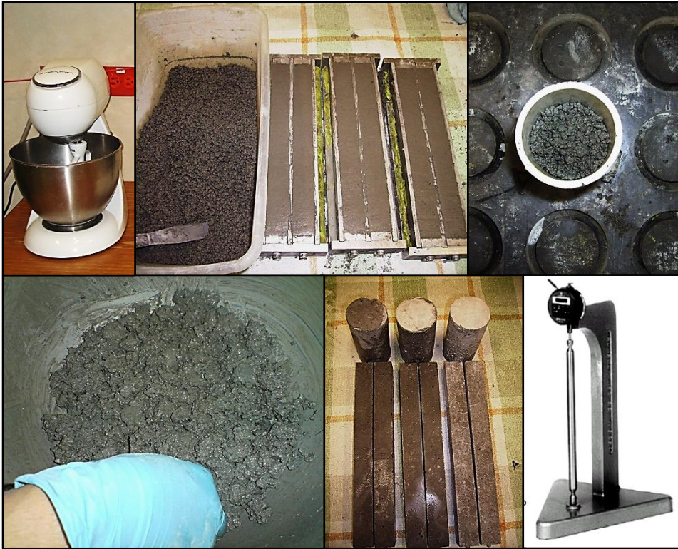
Figura 35.- Procedimiento empleado en la elaboración de morteros.
