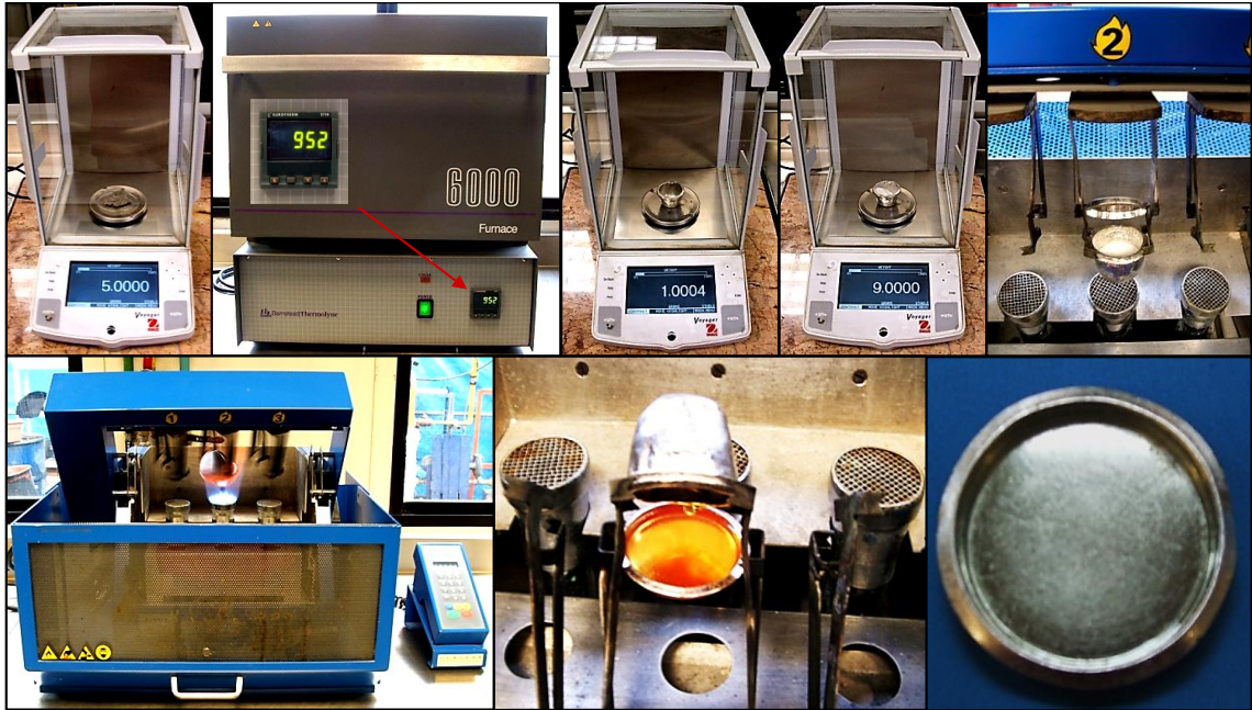
Figura 117.- Procedimiento utilizado para la caracterización de los materiales cementantes mediante FRX a través del método pastilla de vidrio.
