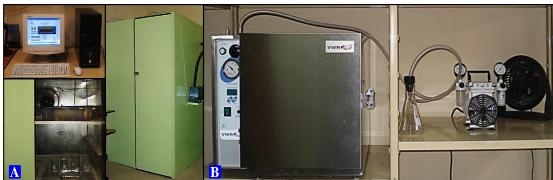
Figura 17.- Equipos para secado del NSG: A) Cámara controlada a 60°C, B) Horno eléctrico equipado con vacío.
