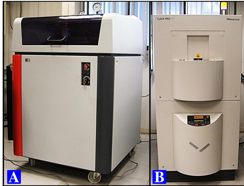
Figura 19.- Equipo para análisis de muestras vía: A) FRX, B) DRX.
