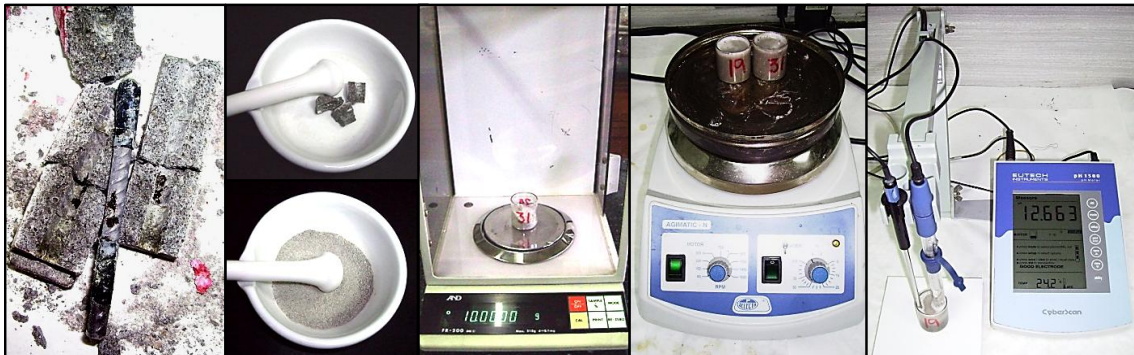
Figura 31.- Procedimiento para la determinación del pH.
