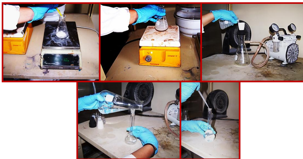
Figura 113.- Procedimiento empleado para la determinación de cloruros totales del NSG.
