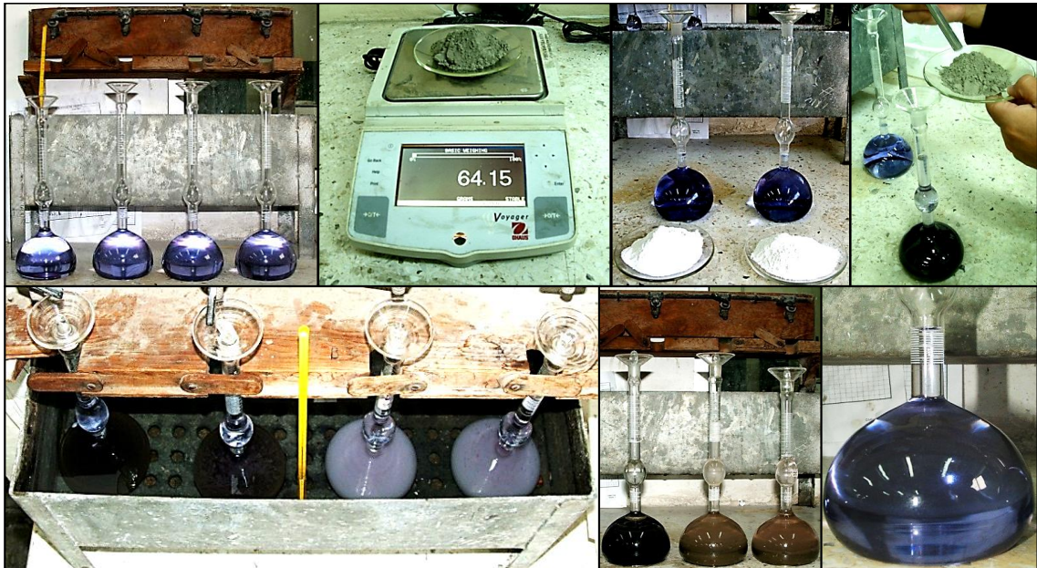
Figura 20.- Procedimiento para la determinación de la densidad de los materiales cementantes.
