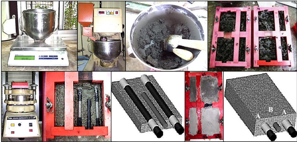
Figura 27.- Procedimiento empleado en la elaboración de morteros prismáticos.
