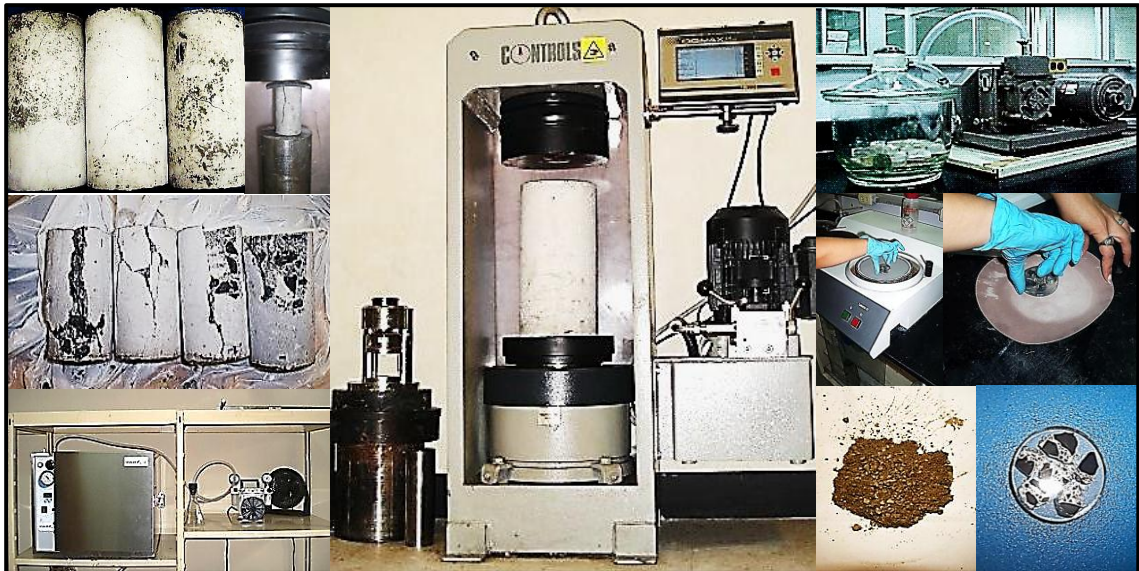
Figura 24.- Proceso de preparación de los concretos para su evaluación mediante: Resistencia a la compresión, microscopía electrónica de barrido y difracción de rayos X.
