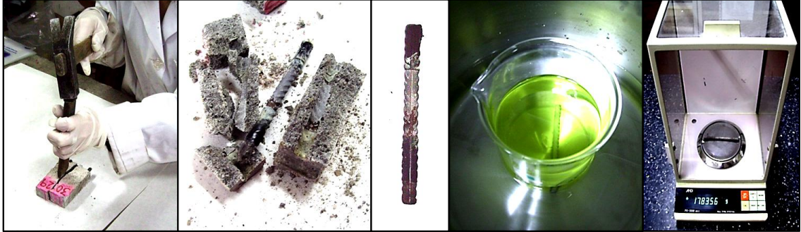
Figura 33.- Procedimiento para la determinación del as perdidas gravimétricas.
