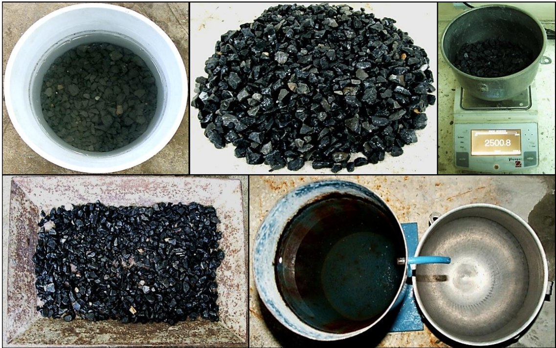
Figura 21.- Procedimiento para la determinación de la absorción de agua en agregados.
