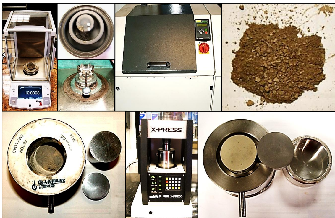
Figura 116.- Procedimiento utilizado para la caracterización de los materiales cementantes mediante FRX a través del método de prensado de polvos.
