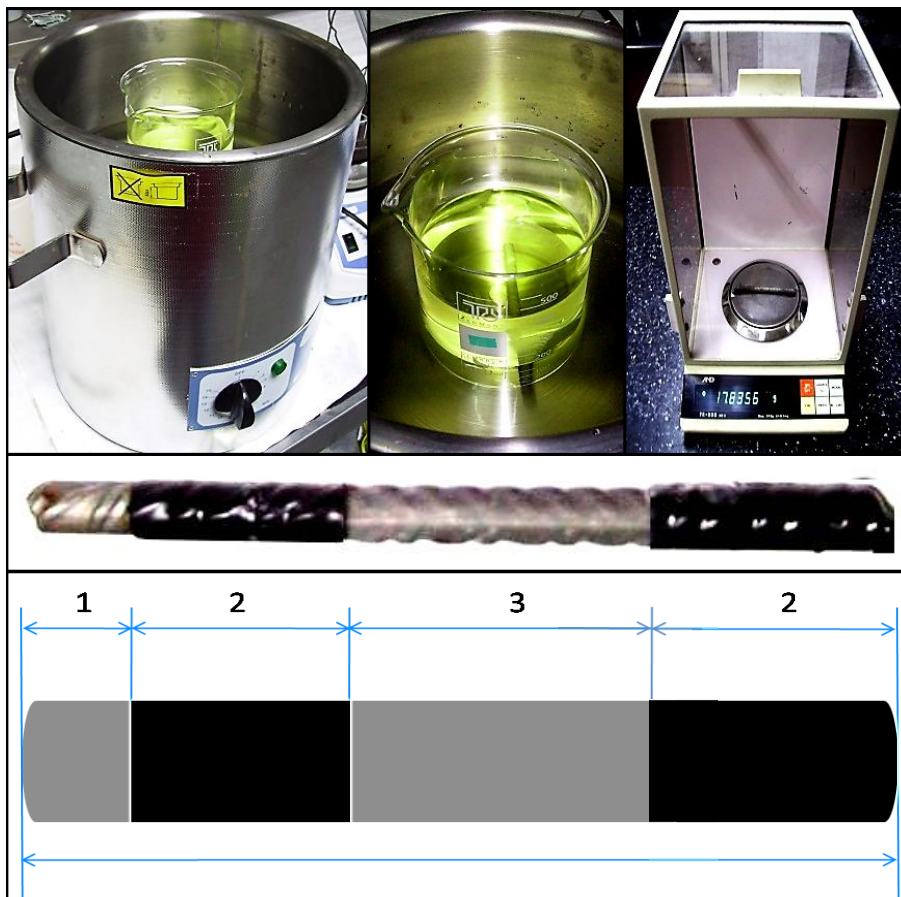
Figura 26.- Decapado y aislamiento de las varillas (dimensiones en cm).
