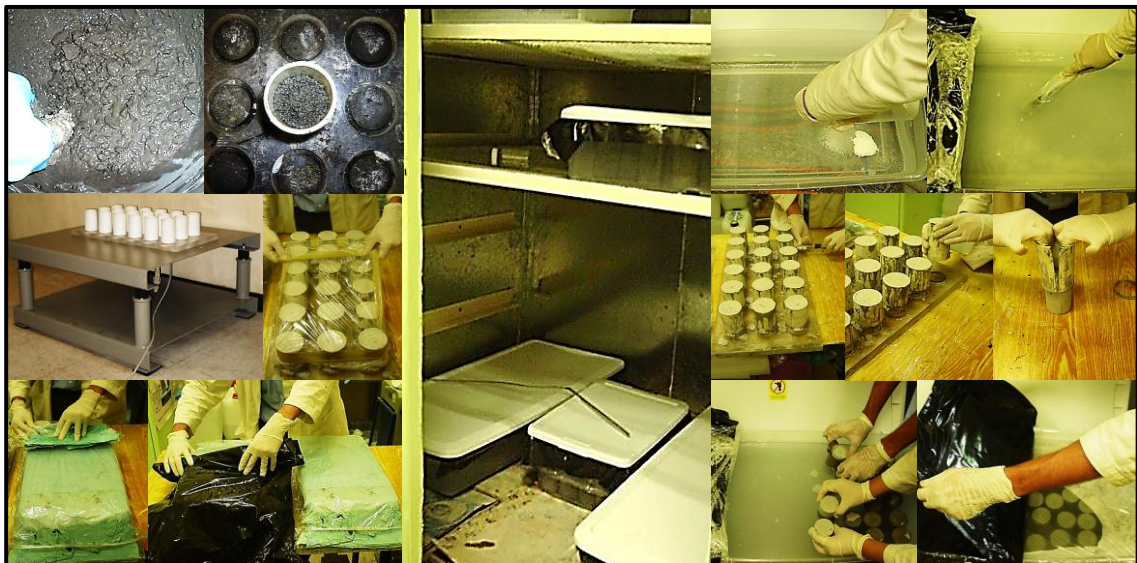
Figura 22.- Proceso de elaboración de los concretos.
