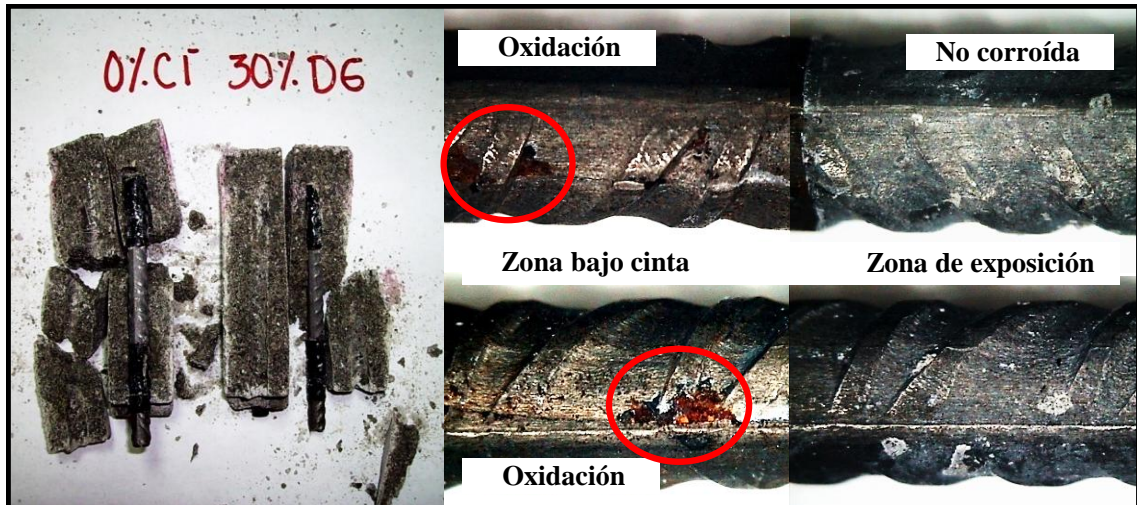
Figura 95.- Estado de pasividad exhibido en las varillas embebidas en morteros adicionados con 30% de NSG de 0% de Cl - totales que fueron fraguados y curados en un ambiente de 20°C, 80%HR.
