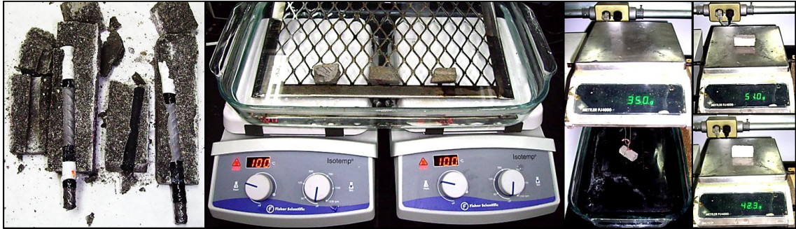
Figura 32.- Procedimiento para la determinación de la porosidad.
