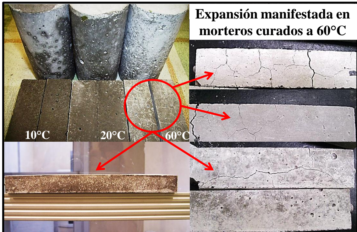
Figura 103.- Morteros cilíndricos y rectangulares adicionados al 20% con NSG de 10% Cl - sometidos a un proceso de curado por 28 días en un ambiente de temperatura exposición de 10, 20 y 60°C.
