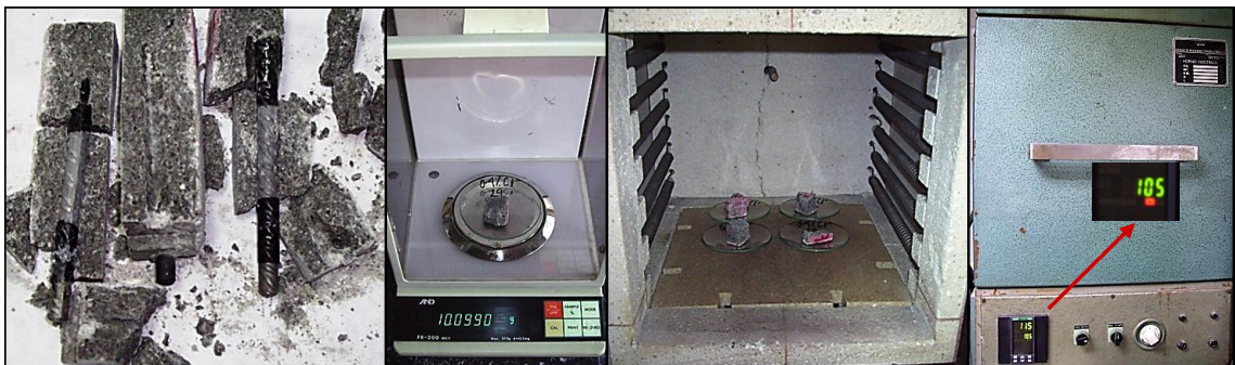
Figura 30.- Procedimiento para la determinación de la pérdidas de agua evaporable.
