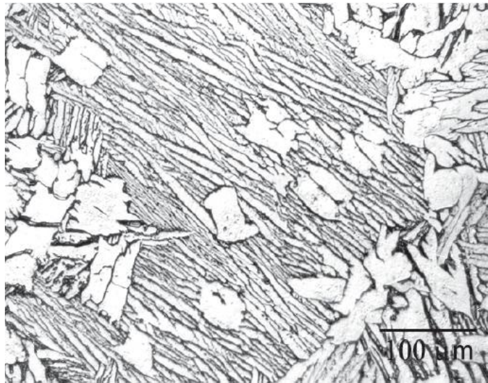
Figura 2.6. a) Microestructura bimodales de la aleación Ti64. [29].
