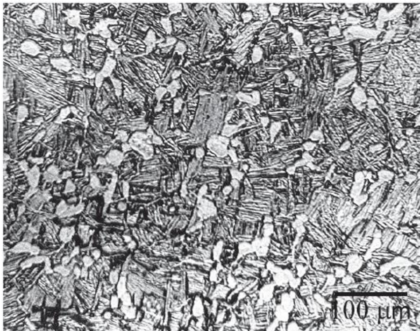
Figura 2.3 Microestructura dúplex de la aleación Ti6246 [28].
