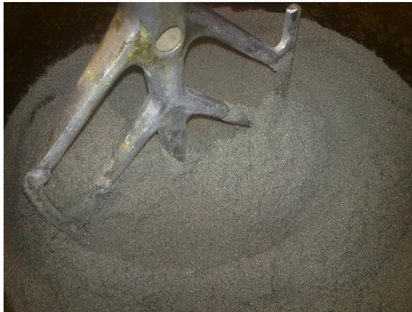
Figura 6.3. Incorporación de la resina de gran viscosidad en la que se dispersaron MWCNT en las condiciones más severas; t60A80.
