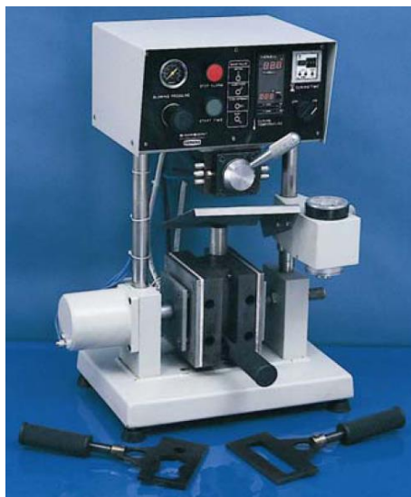
Figura 4.14. Sopladora Simsom Gerosa para fabricar especímenes planos.
