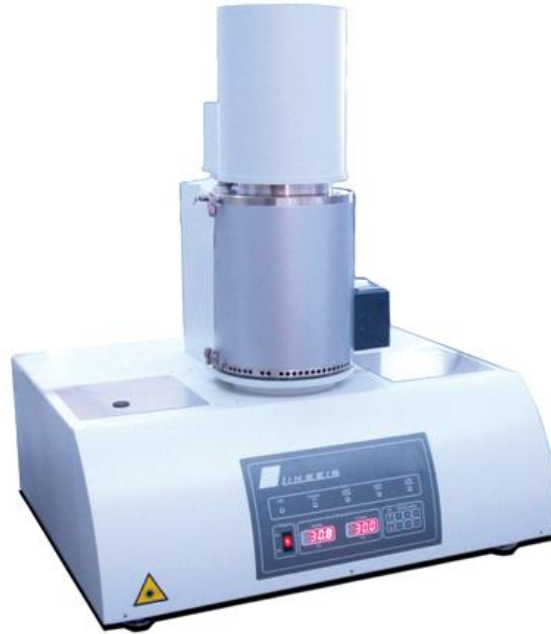
Figura 4.6. Difusivimetro Linseis XFA 500.
