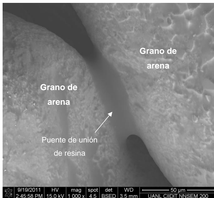
Figura 2.6 Puente de unión entre los granos de arena.
