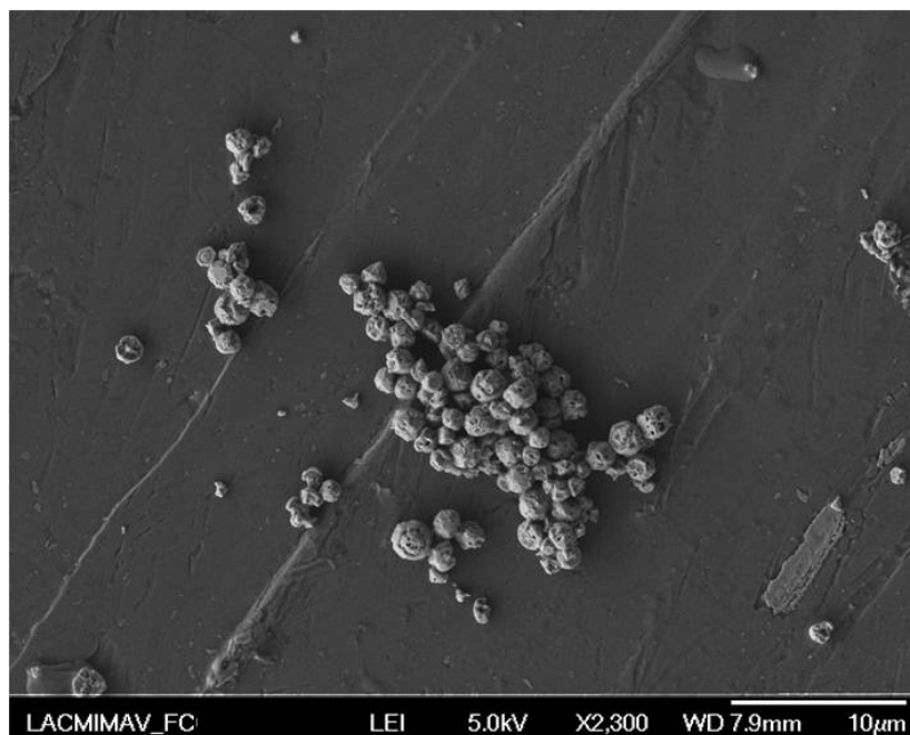
Figura 34. Micrografía electrónica de barrido de las las nanopartículas de ZnO sintetizadas por método solvotermal asistido por microondas.
