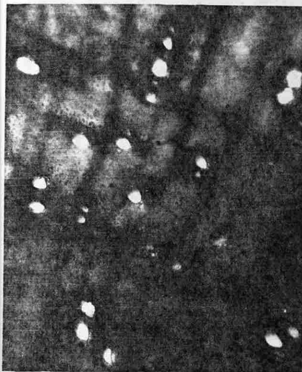
16b. Poros difusos y en pares, parénquima paratraqueal vasicéntrico. (40 X)
