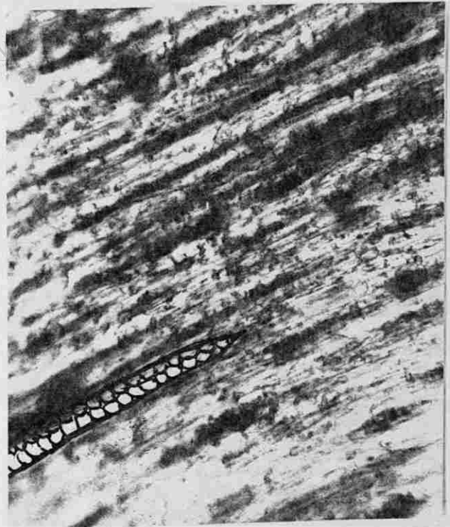
9c. Radios heterogéneos biseriados. (40 X)
