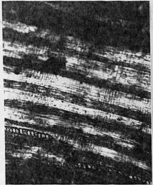
26c, Radios homogéneos uniseriados. (40 X)
