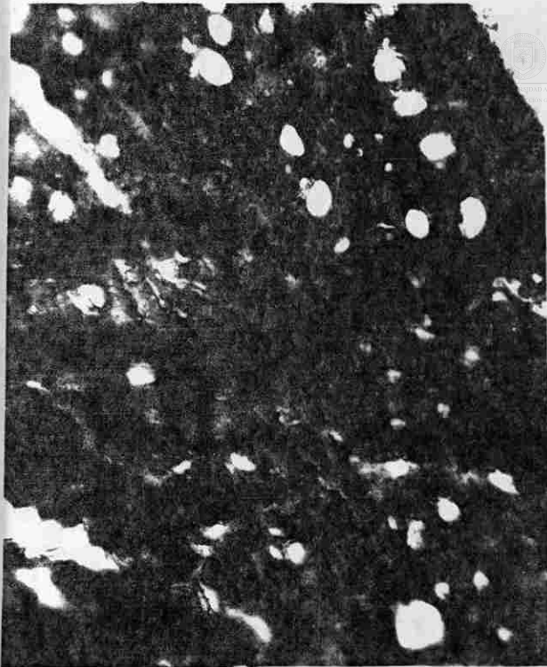
4b. Poros difusos y en línea, parénquima paratraqueal aliforme. (40 X)
