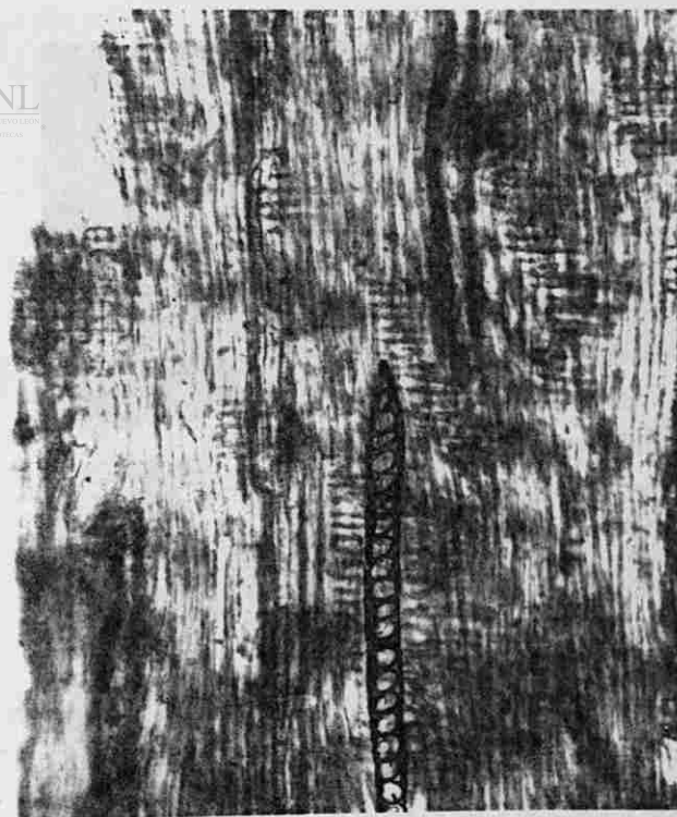
18c. Radios homogéneos uniseriados. (40 X)
