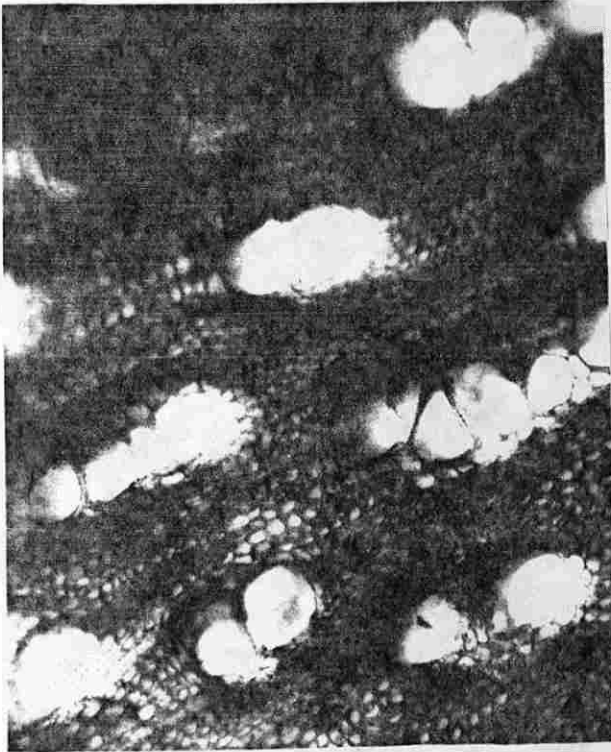
24b. Poros difusos y en pares, parénquima paratraqueal vasicéntrico. (40 X)
