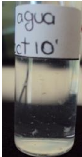
Figura 4-12: En esta imagen se puede apreciar material suspendido en el agua destilada, después de un experimento con PLALM y una muestra sólida de Sb en agua destilada.
