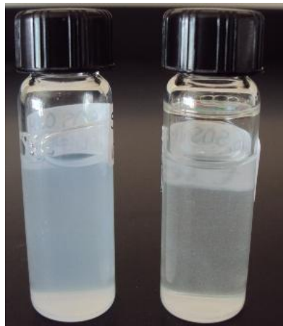
FIGURA 4-2 Soluciones coloidales por PLALM utilizando como blanco las muestras de Sb sólido en SDS
