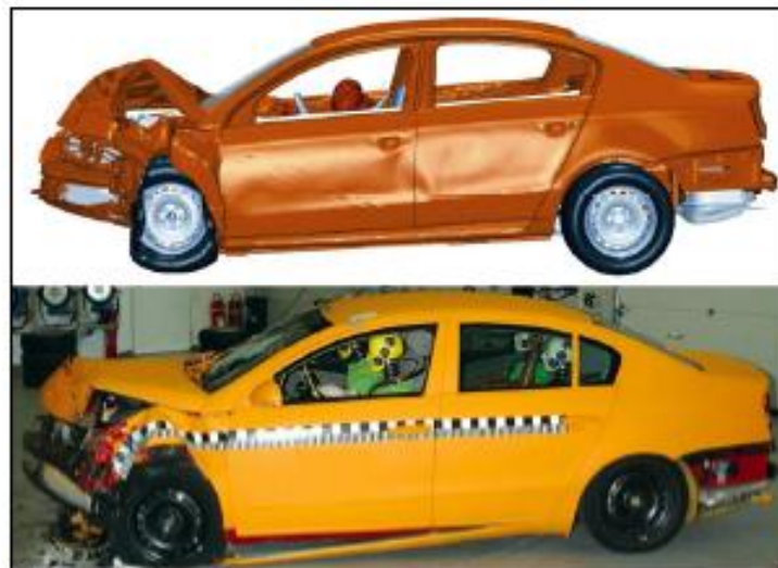
Figura 4.13 Ejemplo simulación de impacto de un vehículo, imagen superior simulación, imagen inferior prueba real, se observa el parecido del resultado final de la deformación entre ambas imágenes [5].
