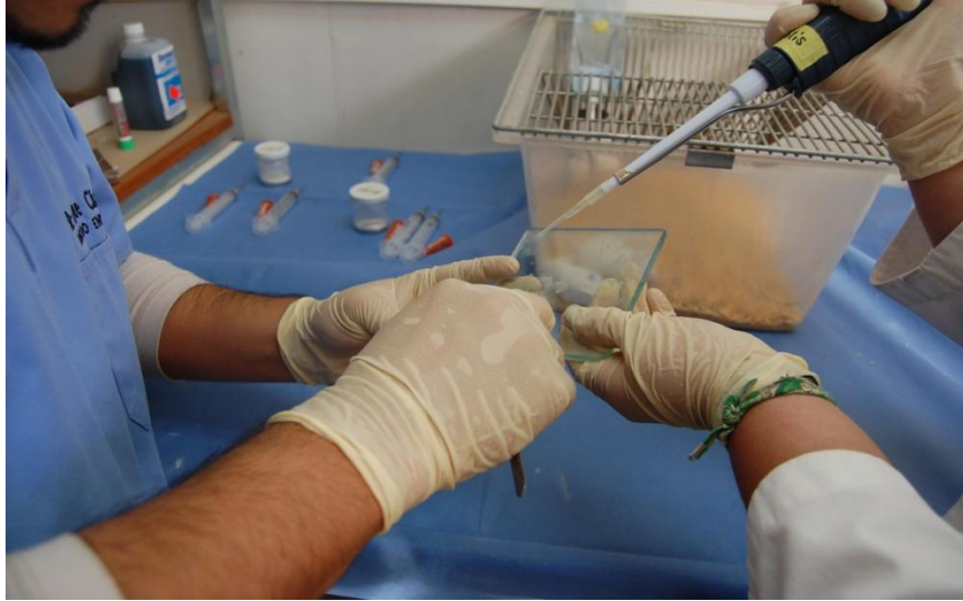
Fig. 3 Colocando agua destilada para mezclar el cemento.
