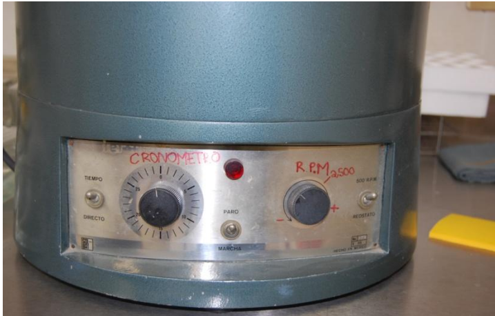
Fig. 7 Centrífuga que se utilizó para separar el suero del plasma.
