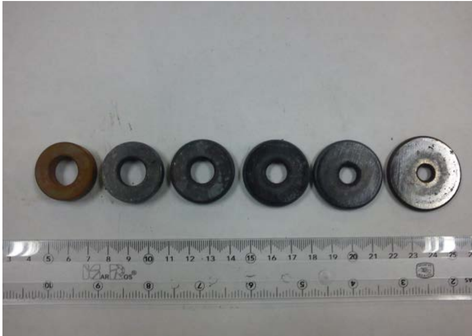
Figura 7.46 - Anillos ensayados a distintos desplazamientos del pistón, de izquierda a derecha: a) 0mm, b) 1mm, c) 2mm, d) 3mm, e) 4mm y f) 5mm
