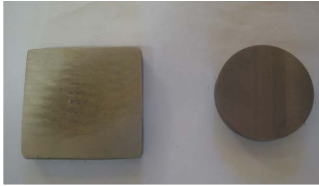
Figura 5.14 - A la izquierda, hierro alto en cromo; a la derecha, el acero de alta velocidad
