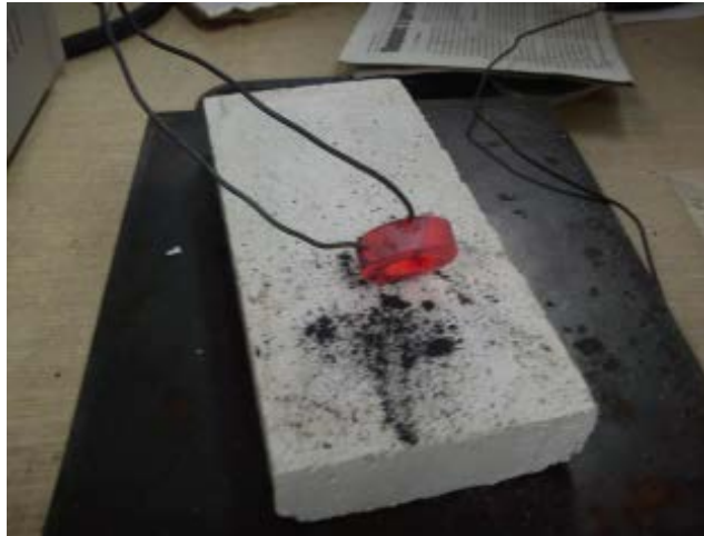
Figura 5.29 - Anillo a alta temperatura con termopares
