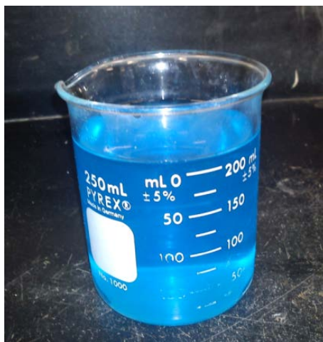
Figura 5.21 - Solución de sulfato de cobre y ácido sulfúrico
