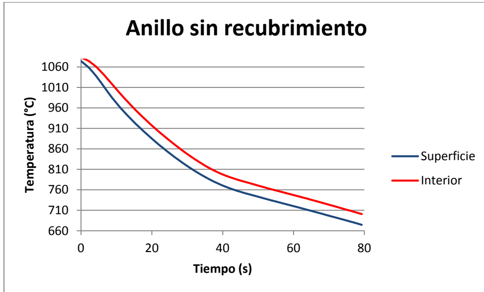
Figura 7.43 - Enfriamiento de anillo sin recubrimiento
