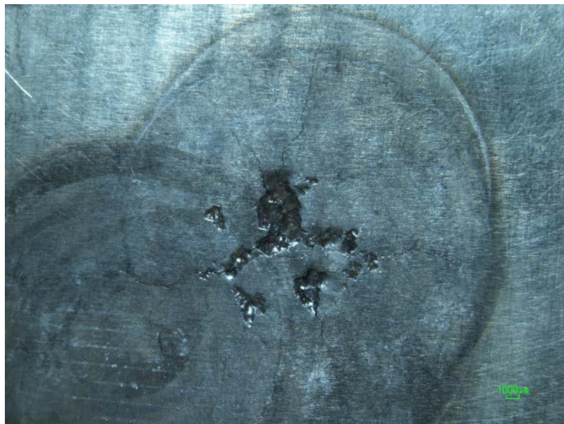
Figura 7.39 - Imagen de estereoscopio del hierro blanco alto en cromo plato inferior
