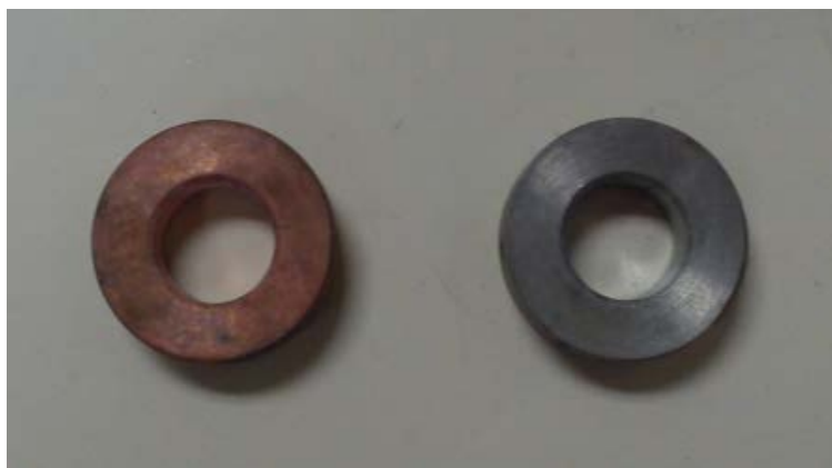
Figura 5.22 - Anillo cobrizado y sin cobrizar
