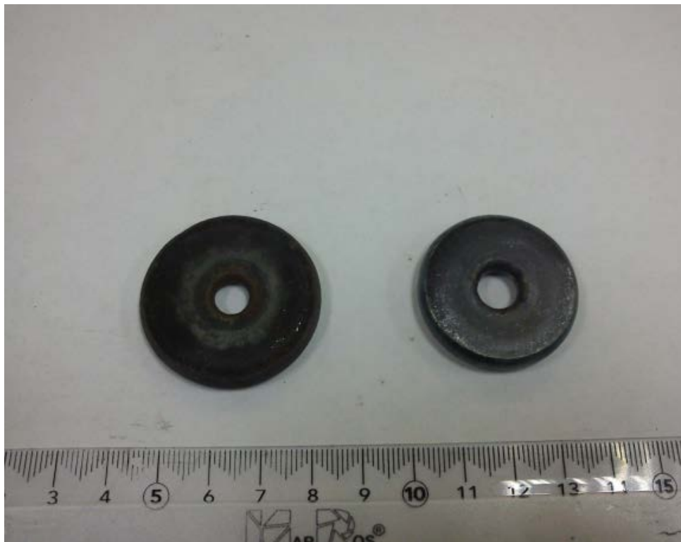
Figura 7.47 - Anillos ensayados al mismo desplazamiento del pistón (5mm) con diferentes recubrimientos. Izquierda sin recubrimiento, derecha con grafito
