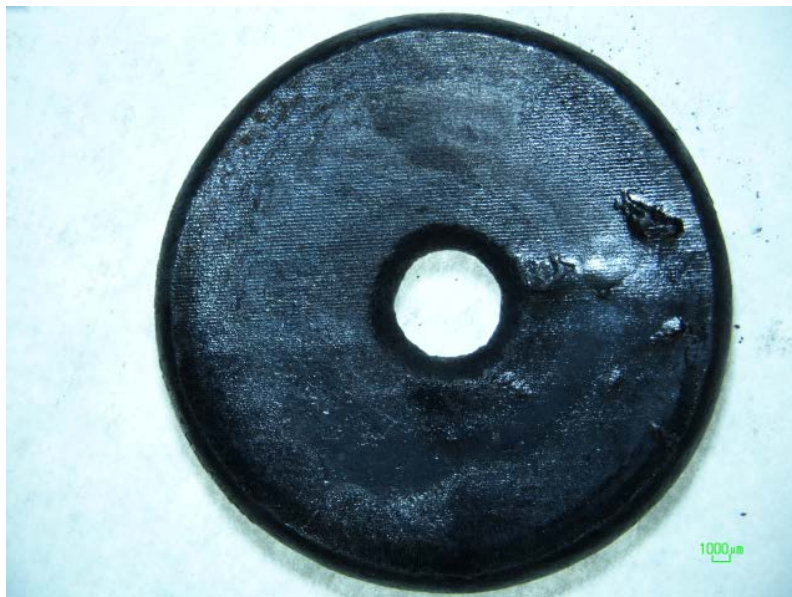
Figura 7.41 - Anillo comprimido por hierro blanco
