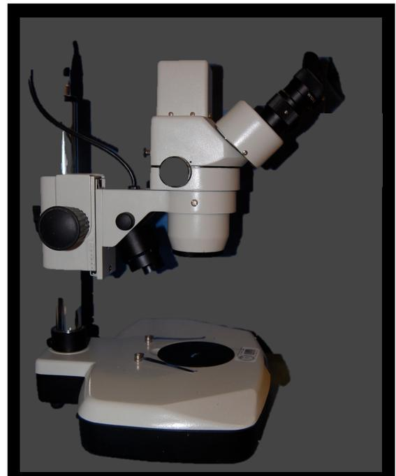
*Figura 10* Estereomicroscopio digital calibrado marca Motic con cámara fotográfica y software (Motic Image 2000 Software, Motic Digital Micros Optic Industrial Group Co, France).
