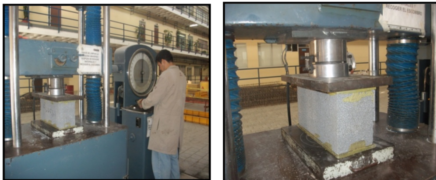
Figura 28. Máquina Universal de Pruebas Riehle, durante la ejecución de la prueba de resistencia a la compresión en bloques de concreto.
