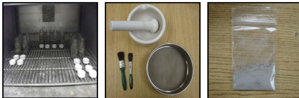
Figura 32. (Izquierda a Derecha). Muestras secadas en horno a 40 °C. Equipo de molienda: Mortero de Ágata, malla No. 200 y brochas. Muestras molidas almacenadas en bolsas de plástico.
