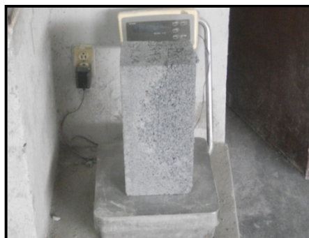
Figura 30. Determinación del peso seco de los bloques de concreto.
