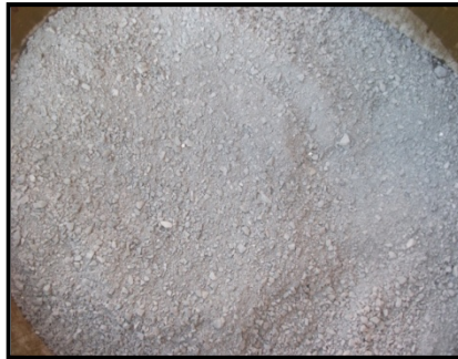
Figura 14. Arena 4B para bloques de concreto.
