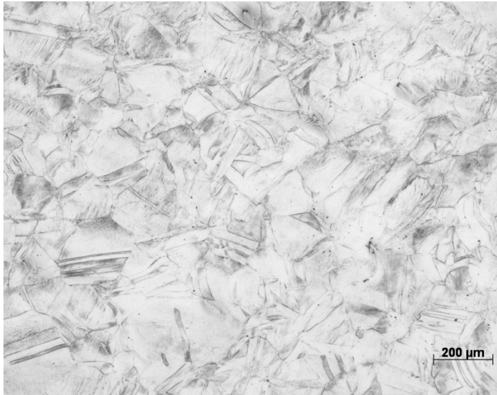
Figura A12. Microestructura de la probeta 12B en condición de materia prima a 50X.
