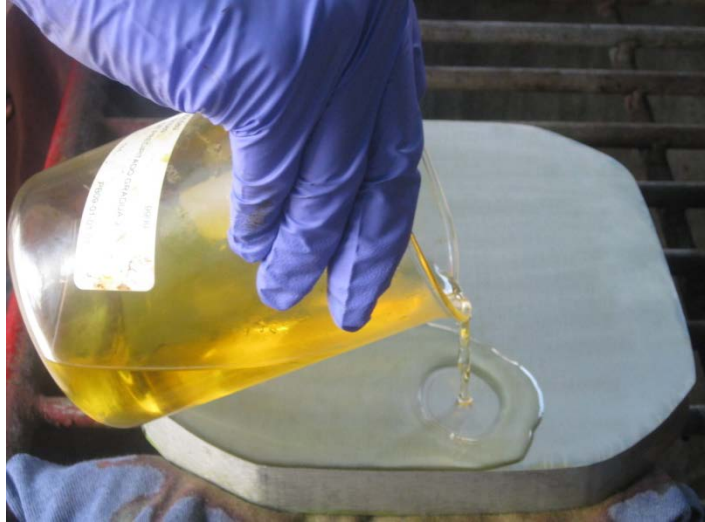
Figura 3.7 Ataque químico a una laja de H-242
