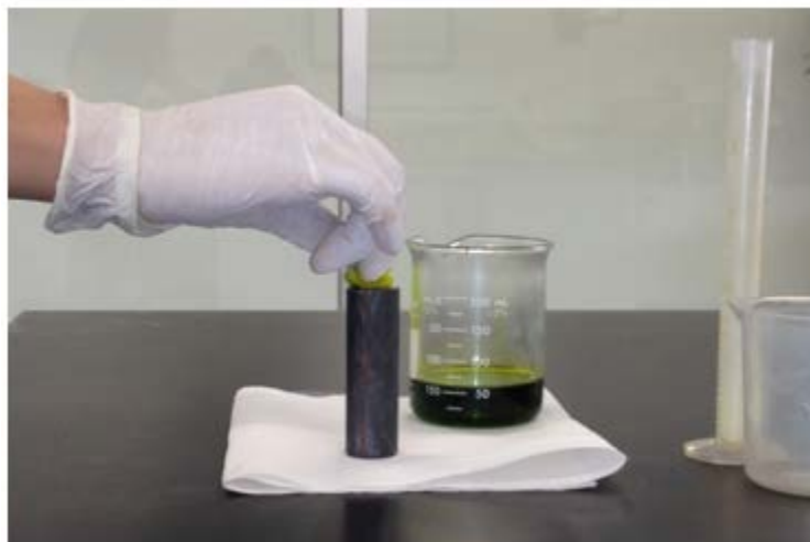
Figura 3.8 Ataque químico de una probeta pre-solubilizada antes de la deformación en caliente.
