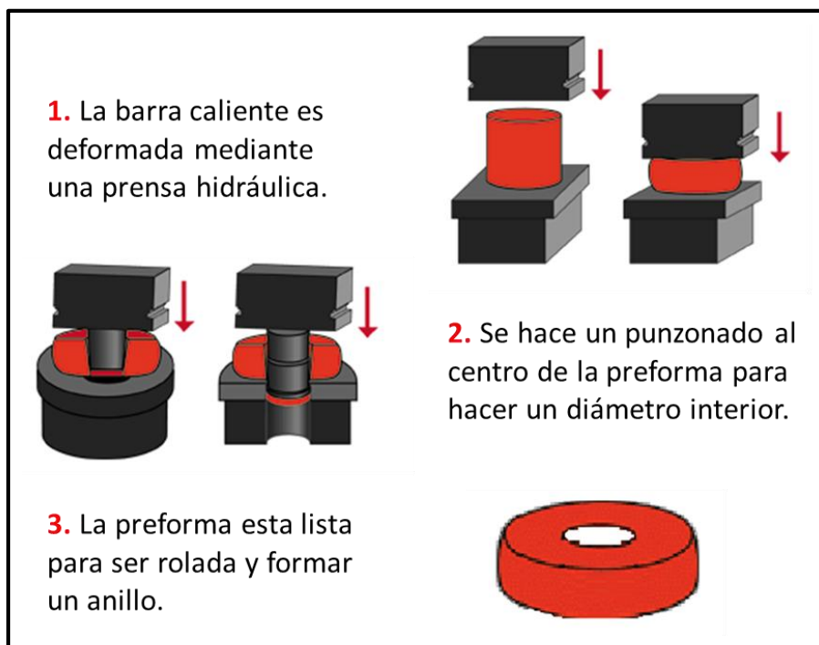
Figura 2.13 Proceso de elaboración de una preforma.
