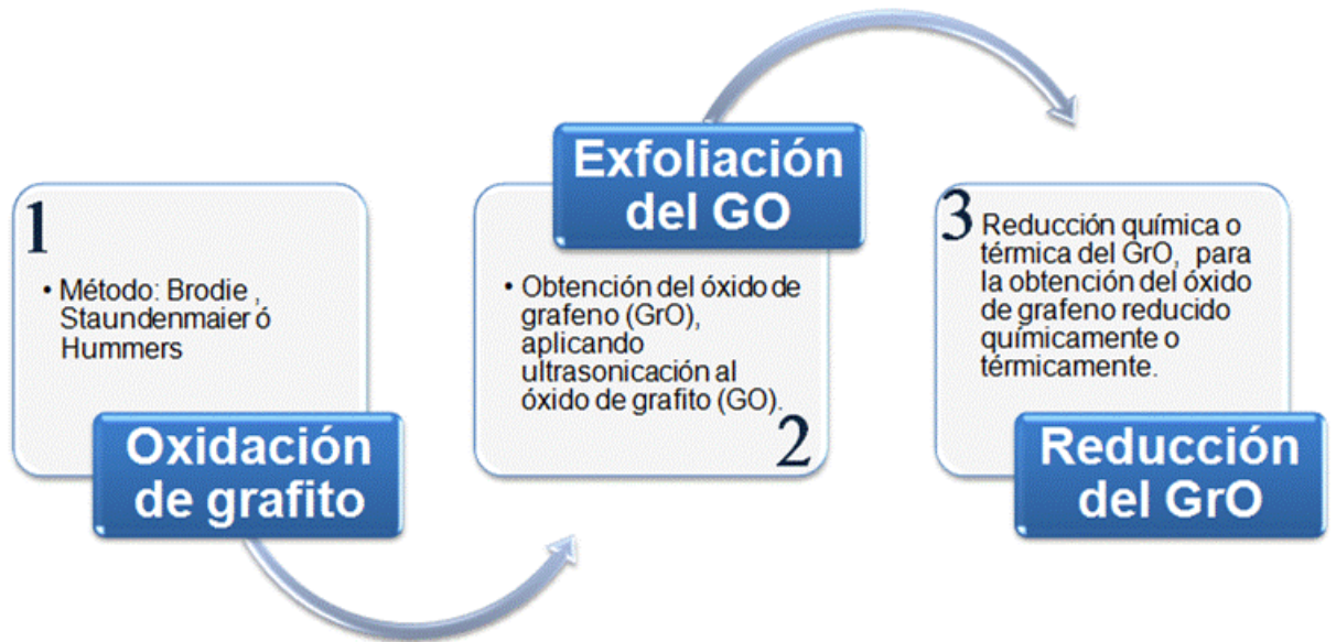
Figura 3.2- Diagrama representativo de las etapas para la obtención del óxido de grafeno reducido térmica o químicamente.
