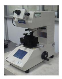
Figura 3.1 Microdurómetro Vickers Shimadsu
