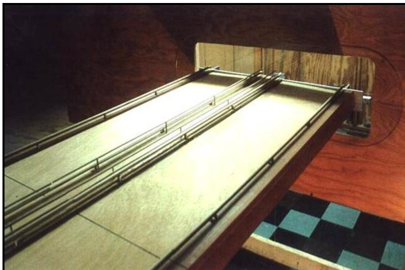
Fig. 3. 8 Modelo seccional del tablero en Pruebas de Túnel de Viento
