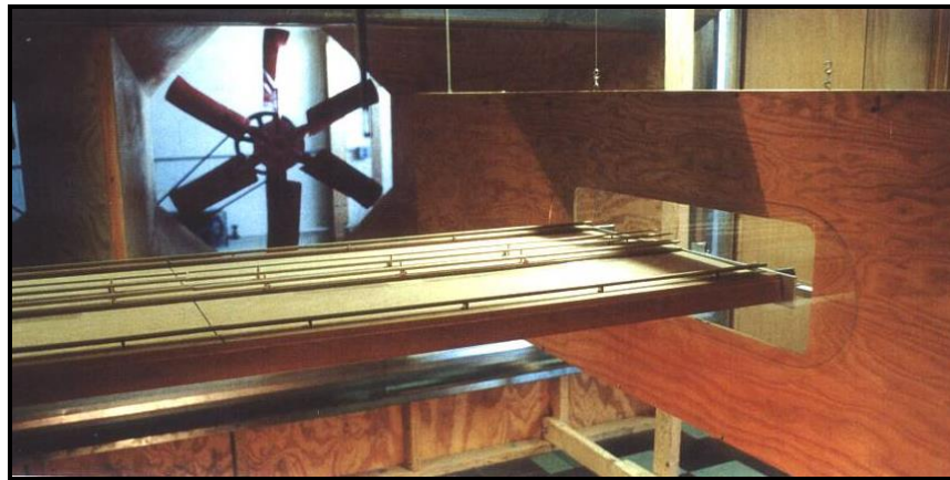
Fig. 7.20 Modelo seccional en el Túnel de Viento
