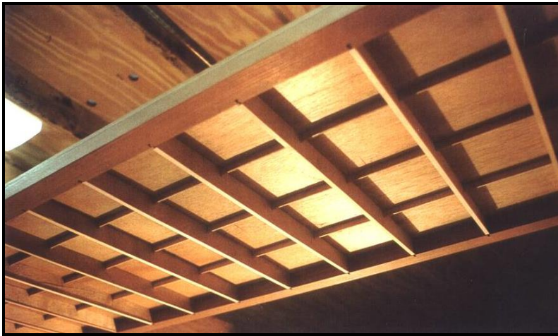
Fig. 7.21 Modelo Seccional del tablero en Túnel de Viento
