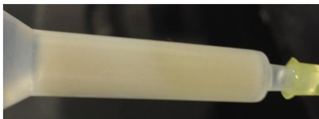
Figura 21 Resina activada con iones plata inmovilizados, resultante de la prueba de estabilidad a 4°C y buffer de fosfatos pH 7.
