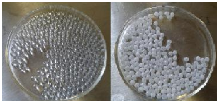
Figura 5. Esferas de vidrio (izquierda) y esferas recubiertas con 10 capas de \text{TiO}_2 sintetizado por vía sol-gel (derecha).
