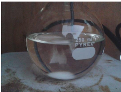
Figura 4. Matraz con el sol de \text{TiO}_2 sintetizado vía sol-gel .
