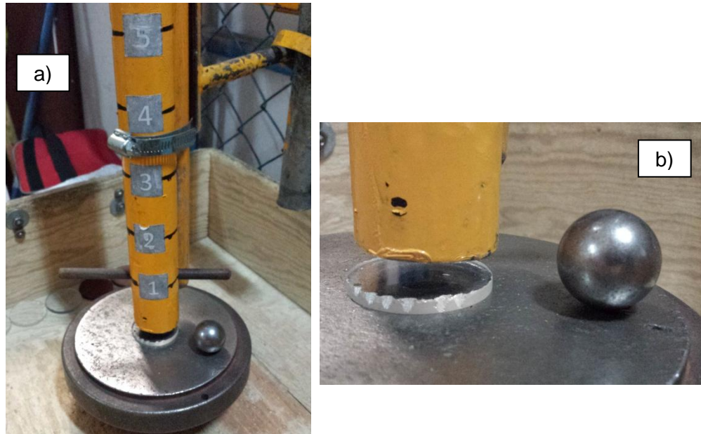
Figura 4.10. Equipo de medición a) Regla Guía; b) Bola de acero de masa conocida
