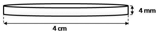
Figura 4.11. Dimensiones de las muestras a someter a la caída de la bola.
