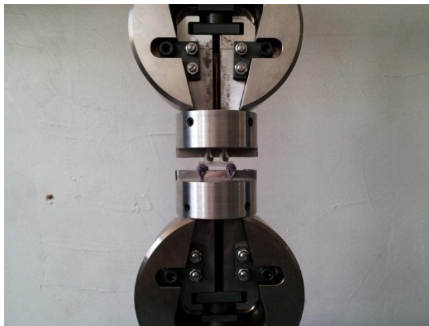
Figura 4.5. Montaje para el ensayo de flexión en cuatro puntos, con una probeta de vidrio de 25 x 10 x 4 mm.
