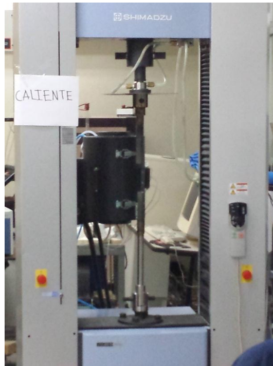
Figura 4.7. Montaje del ensayo de compresión para una probeta cilíndrica de 2 cm de largo por 1 cm de diámetro.
