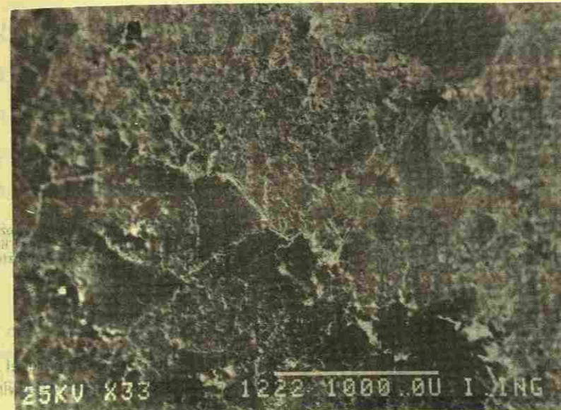
Fig 1 Agrietamiento en la interfase agregado grueso-mortero
