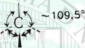
En el dibujo, la cuña indica la posición por encima de la superficie del papel y las líneas punteadas indican posiciones por detrás de dicha superficie. La línea normal indica una posición en la superficie de la página. La figura que se forma conectando la línea es un tetraedro, por lo que este ordenamiento de pares electrónicos es tetraédrico.
