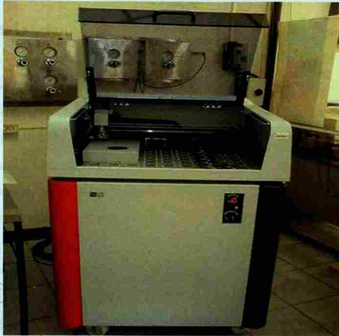
Figura No. 6. Espectrómetro de Fluorescencia de rayos X, Marca Bruker Modelo PIONEER S4 Empleado para el análisis de suelos.
