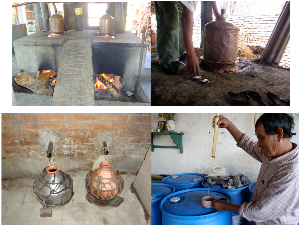
Imagen XVI. Equipo de destilación y la obtención de las “perlas” del mezcal.
