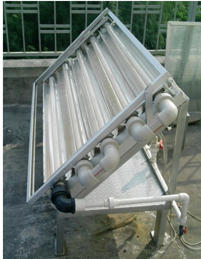
Figura 1.4. Reactor Cilíndrico-Parabólico Compuesto (CPC).
