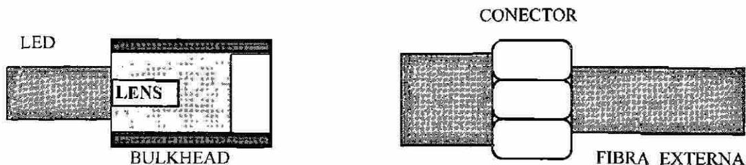
Fig. 4.7 Acoplamiento de un ADM con una fibra óptica.
