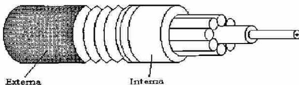
Fig. 7.6 Cubiertas del Cable de F.O.
