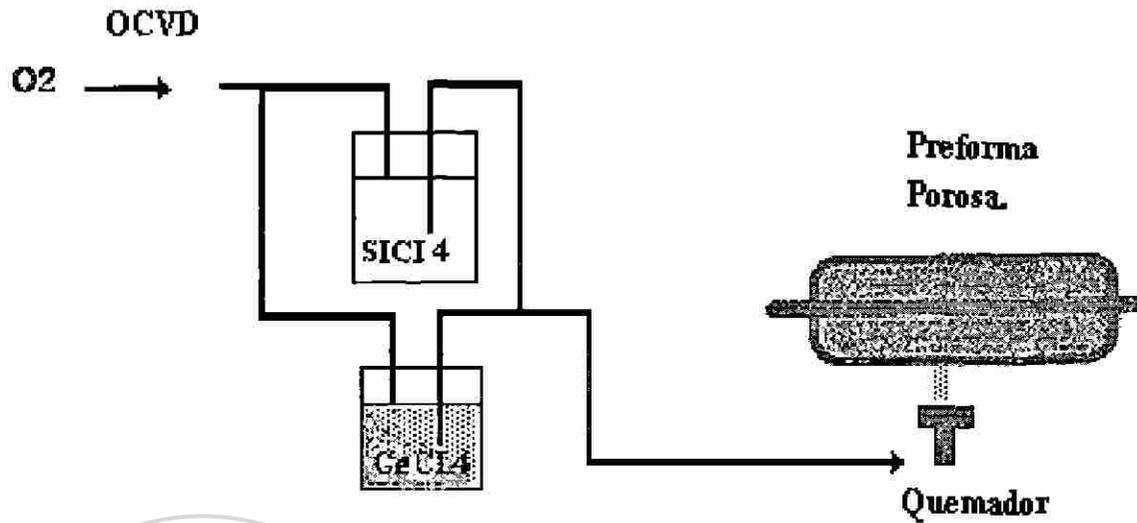
**Método de Deposición externa de vapores químicos.**
