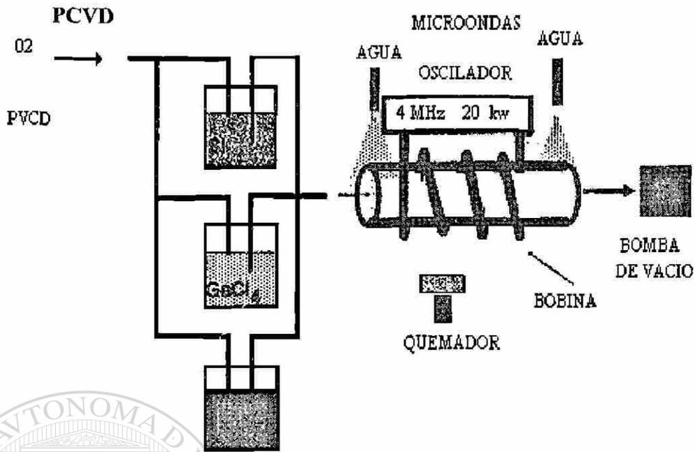
**Método de Deposición de vapores por plasma de radio frecuencia**
