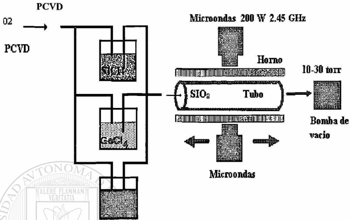
**Método de Deposición de vapores por plasma**
