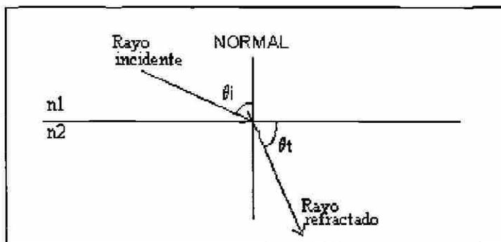
Fig. 3.10 Efecto de la refracción de la Luz en medios menos densos.
