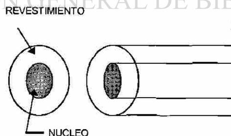
figura 2.1 Núcleo y Revestimiento una Fibra Optica
