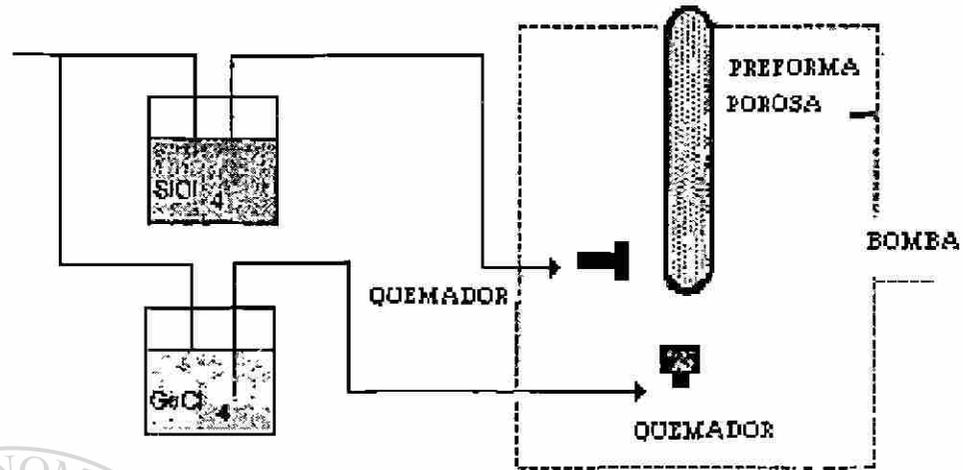
**Método de Deposición axial de vapores químicos**
