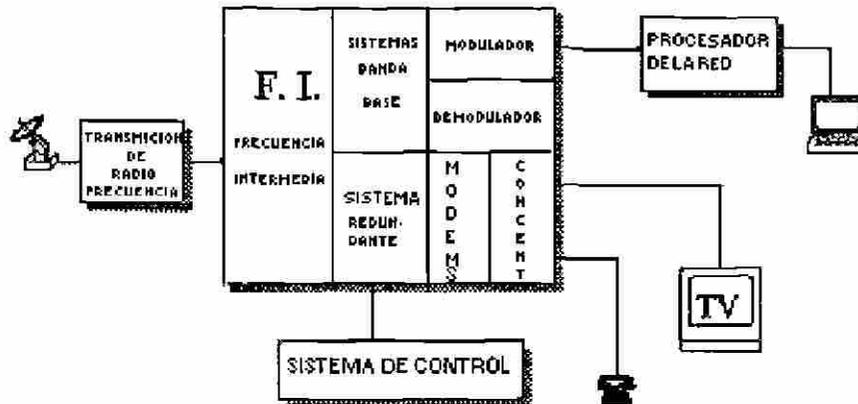
Fig. 10.3 Configuración básica de una estación maestra (HUB)
