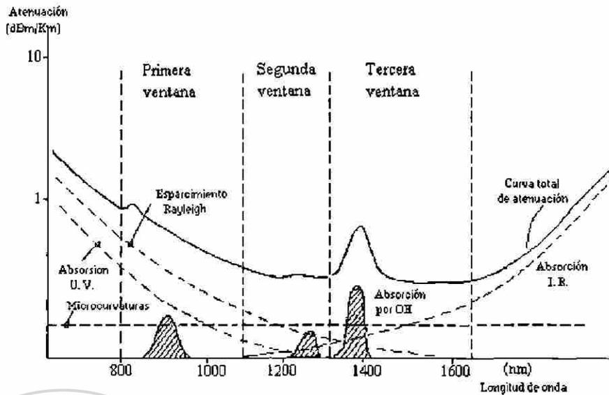
Fig. 4.14 Ventanas de operación de la fibra óptica.
