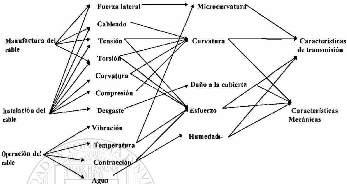
Figura 7.2. Factores en el diseño de un cable.
