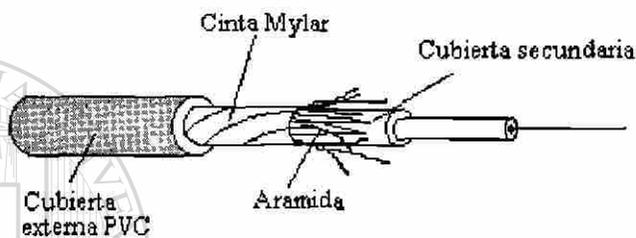
Fig. 7.12 Cable de F.O. para interiores sencillo.
