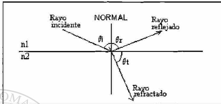
Fig. 3.7 Refracción de la Luz.
