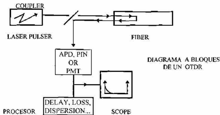
fig. 8.1 Diagrama a cuadros de un OTDR.
