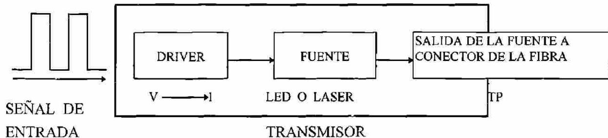
Fig. 4.5 Diagrama a cuadros de un transmisor de fibra óptica.
