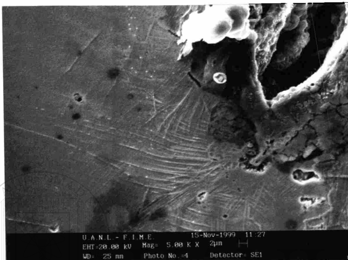
Figura A4 Microestructura correspondiente a la muestra 1 después de 20 ciclos de enfriamiento en aire. Esta imagen presenta el final de una grieta del recubrimiento, la punta de la grieta se encuentra en la interfase entre el recubrimiento y el acero inoxidable, en este último se puede observar líneas de deformación plástica. Esta imagen fue obtenida en el microscopio electrónico de barrido (SEM) El ataque químico utilizado fue una solución de 5 ml HCl, 1g ácido pícrico y 100 ml de alcohol etílico.
