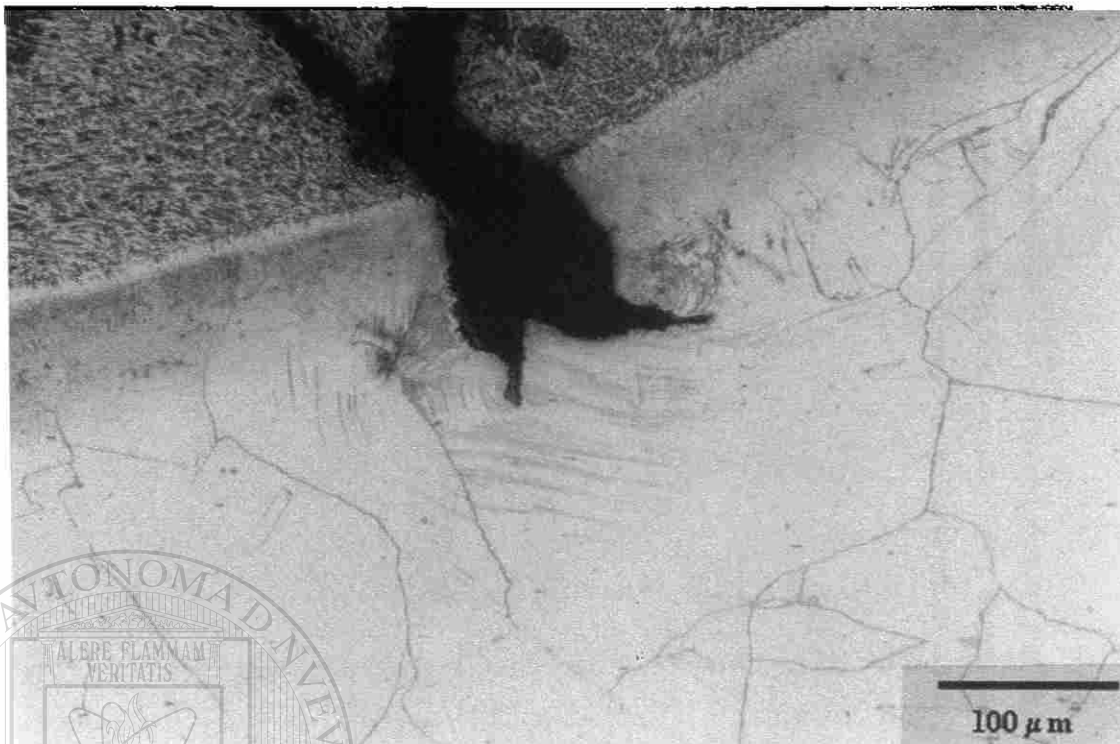
Figura A9 Microestructura correspondiente a la muestra 2 después de 40 ciclos de enfriamiento en agua. Esta imagen presenta una de las grietas que se originaron en el recubrimiento duro la cual termina en un grano austenítico de la microestructura del acero inoxidable la punta derecha de la grieta se extiende a lo largo de la interfase, dentro del grano se observan líneas de deformación plástica. Esta imagen fue obtenida en el microscopio óptico. Se utilizó un ataque electroquímico en el que se empleó ácido oxálico como electrolito.
