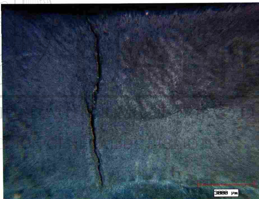
Figura 5.11 Muestra 3 después de 40 ciclos. En esta imagen se observa una grieta en la dirección transversal del tubo, originada por el proceso de soldadura en la aplicación del recubrimiento .
