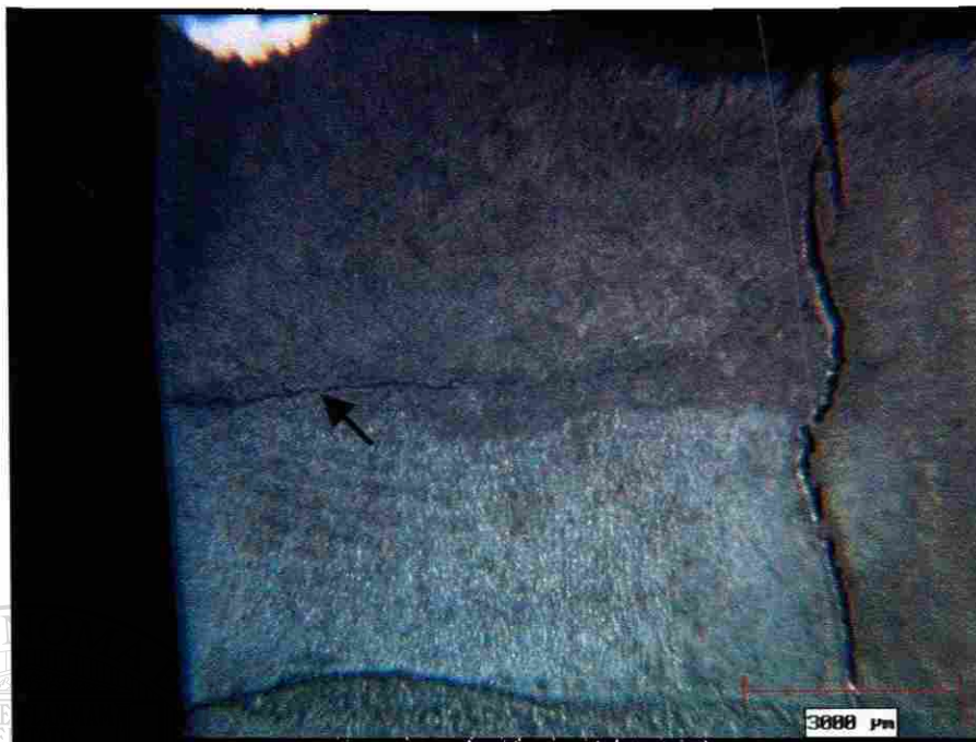
Figura 5.12 Muestra 4 después de 40 ciclos térmicos. En la parte izquierda de la imagen se señala con una flecha la grieta que se genera entre las capas del recubrimiento duro.
