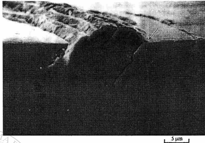
Figura 3.7 Iniciación de una grieta por fatiga en una aleación de cobre[1].
