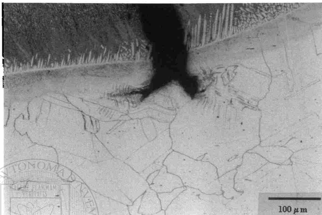
Figura A8 Microestructura correspondiente a la muestra 2 después de 40 ciclos de enfriamiento en agua. Esta imagen presenta una de las grietas que se originaron en el recubrimiento duro durante el ciclado térmico, una de las punta de las grietas (la izquierda) se propaga a lo largo de la interfase del recubrimiento y el metal base. Esta imagen fue obtenida en el microscopio óptico. Se utilizó un ataque electroquímico en el que se empleó ácido oxálico como electrolito.
