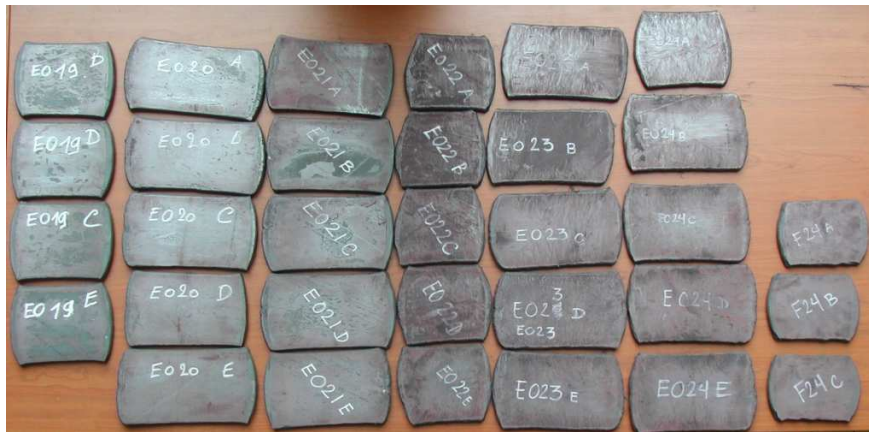
Fig. 6.12. Piezas después del primer laminado en caliente a 15 mm de espesor.
