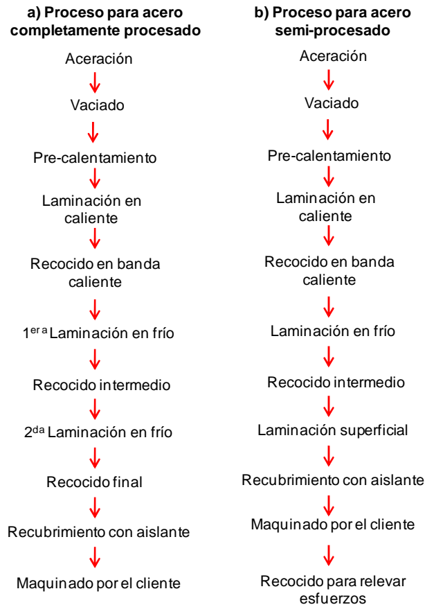
Fig. 2.2. Procesos de fabricación en aceros eléctricos de grano no-orientado para a) materiales completamente procesados, b) materiales semi-procesados.
