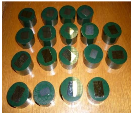
Fig 6.21. Ejemplo de muestras montadas en baquelita del primer programa de laminación en caliente.
