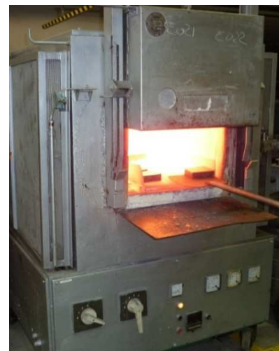
Fig. 6.11. Horno de precalentamiento.
