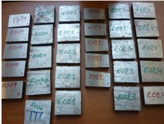
Fig. 6.9. Piezas preparadas que fueron cortadas antes de laminarse en caliente.
