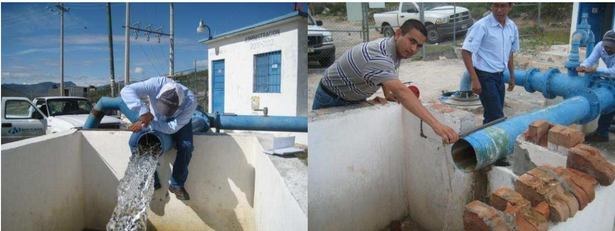
Figura IV.8.- Medición del gasto con la escuadra en el pozo Jagüey 2, apoyado por personal de Aguas de Saltillo (AGSAL).
