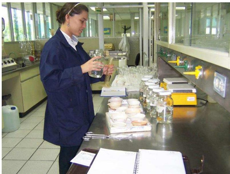
Figura V.3.- Preparación de las muestras para los análisis geoquímicos. Laboratorio de geoquímica COMIMSA S.A. de C.V.
