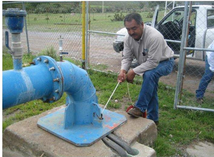
Figura IV.7.- Medición del nivel estático y dinámico en el pozo Santa Fe 3. Con la sonda sonora.
