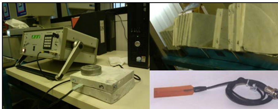
Imagen 14. Equipo de conductividad térmica CT Mètre (izq.), especímenes (Sup. Der.) y sonda de alambre plano (Inf. Der.)
