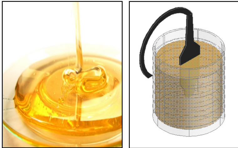
Imagen B1. Jarabe de maíz (izq), esquema de medición de la conductividad térmica de polvo utilizando jarabe de maíz(derecha)
