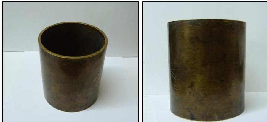
Imagen 9. Contenido de aire en morteros, ASTM C 185.
