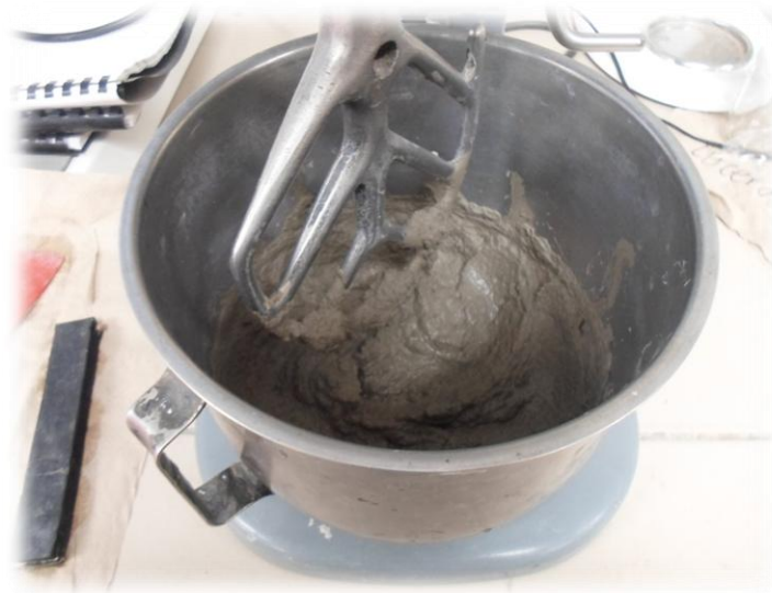
Figura 3. 5 Preparación para la obtención de la mezcla de morteros con una relación de 0.65 (ASTM C305-2007)
