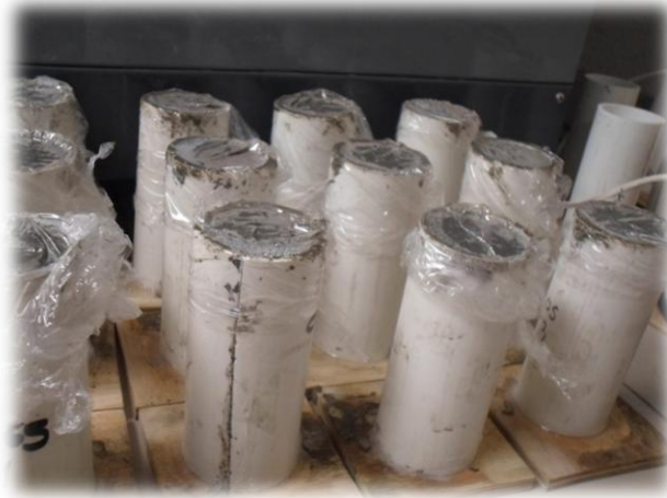
Figura 3. 6 Conservación de los especímenes de mortero, posterior al colado.
