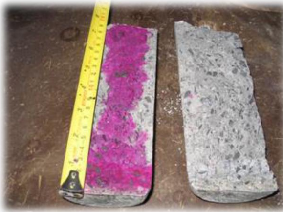
Figura 3. 115 Núcleo ensayado y aplicación del indicado alcalino (San Miguel et al., 2012).
